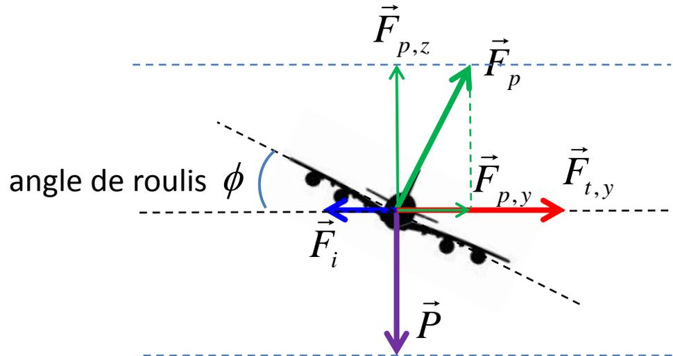
Il existe une force d'inertie  $F_i$  centrifuge liée à l'accélération centripète de l'avion ( $V_p$  est la vitesse propre de l'avion et  $R$  le rayon de la trajectoire)
