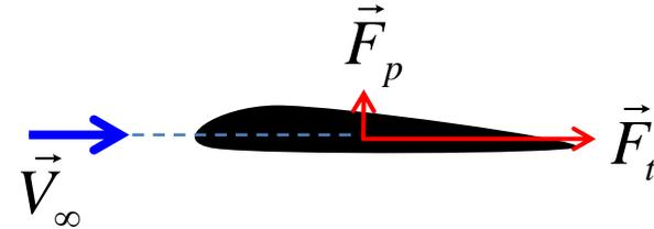
**Remarque 1 :** une aile d'avion à incidence nulle génère un peu de portance car l'écoulement est dissymétrique autour de l'aile.
