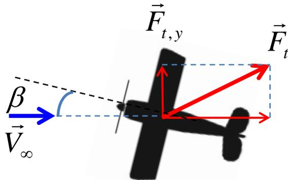
**Remarque 2 :** la force de traînée se décompose en une force parallèle à la direction du vent relatif et une force perpendiculaire. La direction de cette force est indépendante du fuselage.
