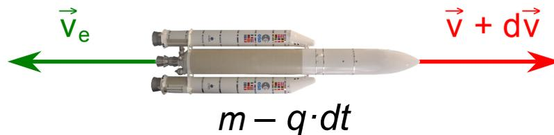
Entre l'instant  $t$  et l'instant  $t + dt$ , la fusée a éjecté des gaz de combustion avec le débit massique  $q$  et à la vitesse  $\vec{v}_e$  (mesurée dans le référentiel de la fusée).
