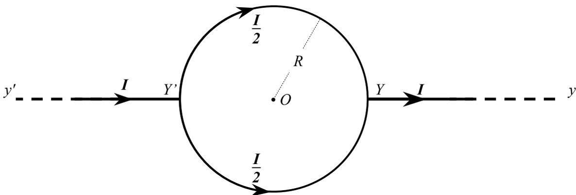
Ce circuit est constitué de deux fils semi-infinis  $y'Y'$  et  $Yy$  reliés par une spire circulaire de centre  $O$  et de rayon  $OP = OP' = R$ . Les points  $Y$  et  $Y'$  sont diamétralement opposés et l'intensité totale  $I$  se divise en deux parties égales ( $I/2$ ) dans les 2 demi-spires.
