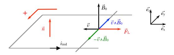
La force de Lorentz  $\vec{F}_{\rm M} = -{\rm e} \ \vec{v} \wedge \vec{B}_0$  s'exerçant sur les électrons est selon  $-\vec{e}_{\rm y}$ . Le courant induit circule donc dans le sens positif
