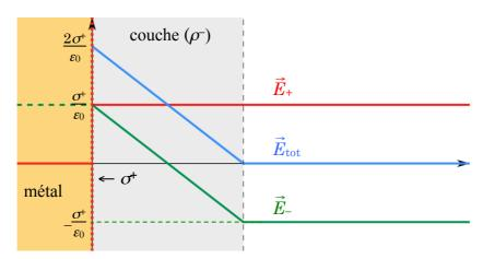
La couche d'épaisseur  $\ell$  permet donc d'obtenir un <u>écrantage</u> du champ électrostatique crée par la densité superficielle de charges  $\sigma^+$ .
