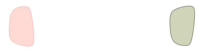
On rapproche les deux conducteurs. S'ils ne sont pas au même potentiel, un champ électrique apparaît entre les deux.
